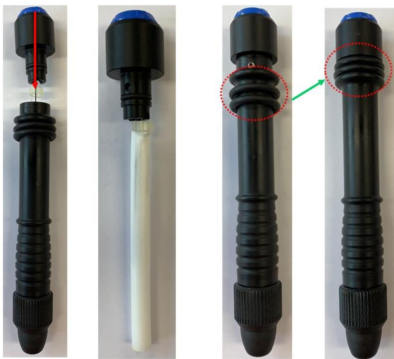
2.6、 将 EC-PEN 电化学腐蚀测试笔的电极连接线从笔的上端连接好， 即可进行准备测试。
