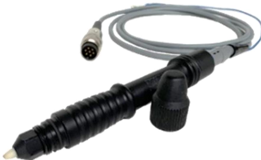
EC-PEN 电化学腐蚀测试笔是实际条件下腐蚀电化学测试的传感器。使用 EC-PEN 可以进行现场电化学测量，从而确定有关腐蚀速率的相关信息。EC-PEN 配有集成电极和电解液，从而便于携带和使用。EC-PEN 可以与任意形状和大小的待测物接触连接，以快速测定材料局部的腐蚀性。如图一所示，EC-PEN 包括一个电解液存储体，从而将 Ag/AgCl 参比电极和 Pt 丝对电极浸入其中。测量时将 EC-PEN 的尖端（多孔隔膜）放在待测部件的目标测试位置，电解液将从 EC-PEN 的尖端流出并润湿局部待测面。只需经过简便的准备就可以快速实现样品的电化学腐蚀测量。正是由于 EC-PEN 的便携性、简单的预处理性，对测试样品的无要求性，从而开辟了 EC-PEN 在腐蚀领域的原位无损检测性。EC-PEN 是免维护的，通常大约允许 200 到 500 次测量，笔尖测量面积为  $1.5\text{mm}^2$ 。
